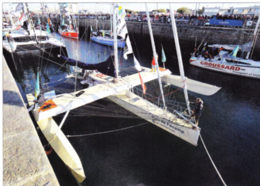
Au passage de l'écluse, PIR2 révèle son bras caisson en alu typique des plans Langevin.
