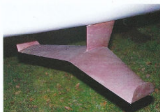
Chaque foil en alliage au magnésium ne pèse qu'une vingtaine de kg. Grâce à leurs "fences" d'extrémité, ils soulèvent le flotteur dès 12 nœuds de vitesse.
