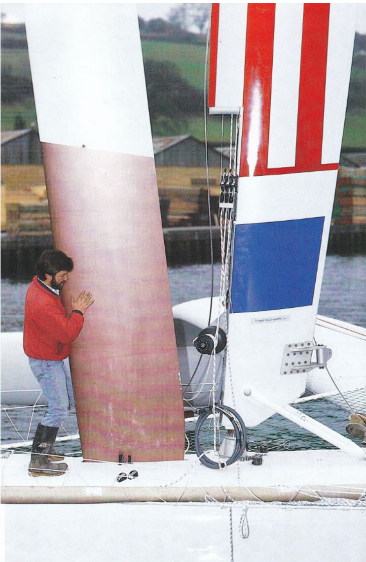
La partie basse de la dérive peut casser sans endommager le puits.
